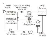
控制循环系统由止回阀、流量计、降压孔板、回流控制阀、电磁阀组成。控制循环系统能够提供最小流量保护,当工艺流量大时,回路关闭,没有额外的能量损失。但系统元件多,购买、安装、维护费用高。
